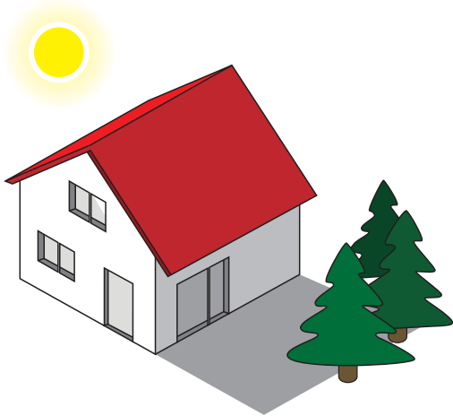
Затененный фасад – среда, благоприятная для микроорганизмов
