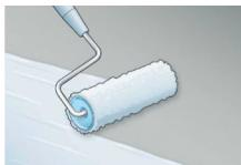
**⚠️ Svarīgi – pēc hidroizolācijas nožūšanas vidējais sausās plēves biezums SAKRET hidroizolācijai: OAD ELASTIC – sienām - 0,4mm, grīdām - 0,6mm.**
